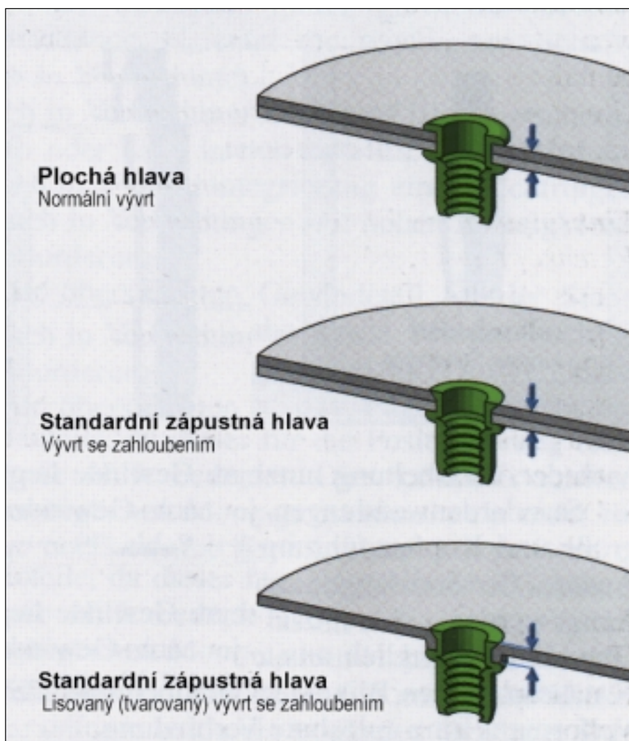
obr. 12: Tvary hlav jednostranně uzavíraných maticových nýtů
