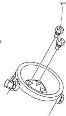
**Hinweis** Ausgewechseltes Mundstück (1) reinigen und mit Rohrsteckschlüssel SW11 (24) in die Aufnahmebohrung an der Unterseite des Nietwerkzeuges einschrauben
