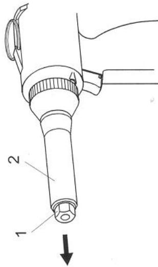
**Hinweis** Bei festsitzendem Mundstück (1) eventuell Nietwerkzeug in einen Schraubstock einspannen und Mundstück lösen. Wenn Sie das Nietwerkzeug in einen Schraubstock einspannen, setzen Sie ein weiches Zwischenmaterial ein (Alu/Holz).
